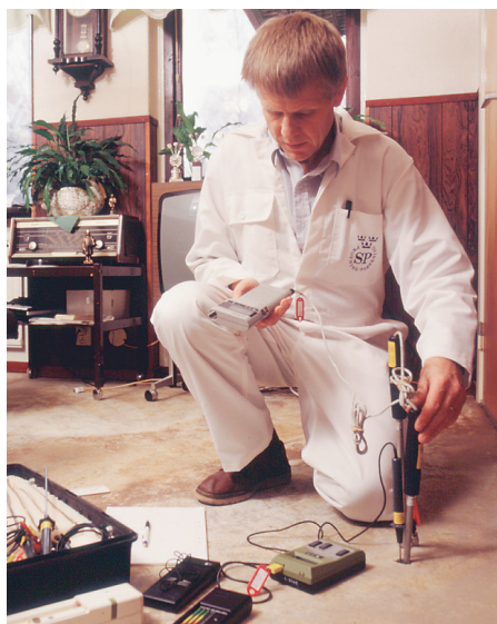
Figur 3: När orsaken till problemen finns i golvet är det viktigt att mäta dels var skadorna finns, dels för att finna orsaken till varför de inträffat.
