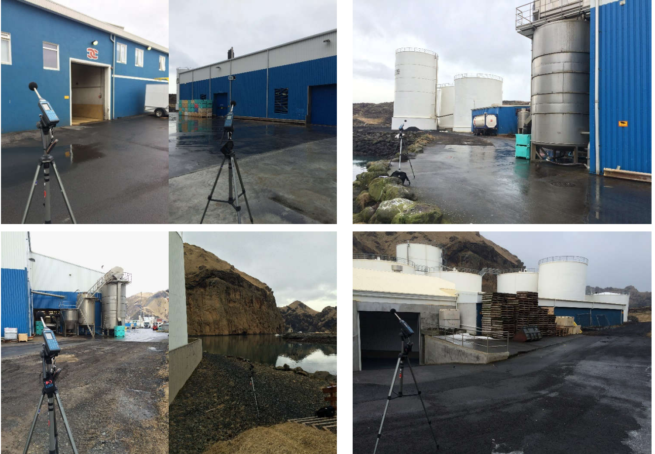
Mynd 2. Staðsetning hljóðnema á (a) mælistað 101 og 103, (b) mælistað 104, (c) mælistað 105 og 107 og (d) mælistað 109.
