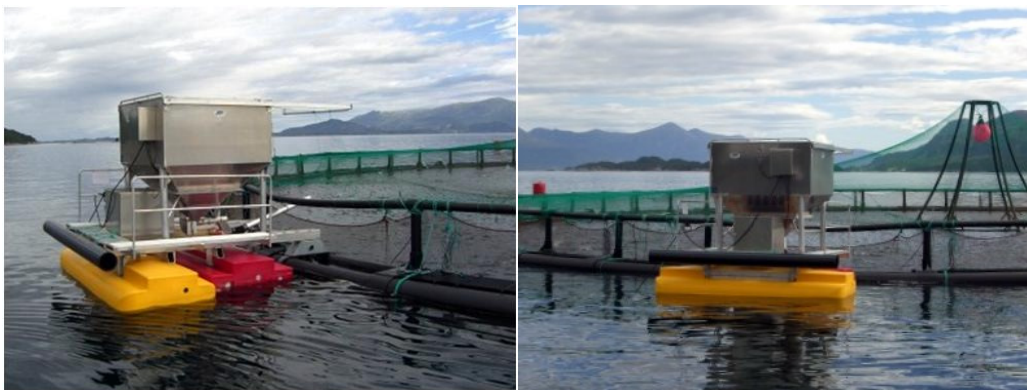
Mynd 1 a,b. Dæmigerður sjálffóðrari sem tekur 1-3 daga fódurskammt og verða notaðir samhliða handfóðrun á laxinum.
