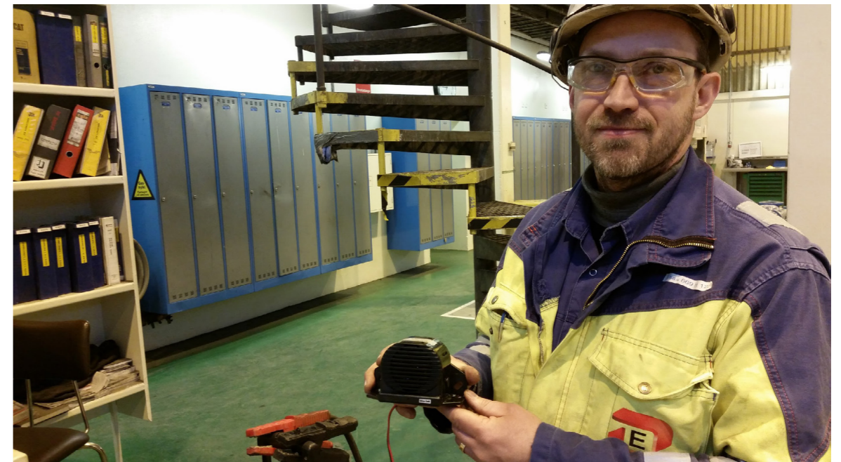
Elías Þorsteinsson með nýja gerð af bakkflautu sem mun draga úr myndun hávaða á útisvæði.
