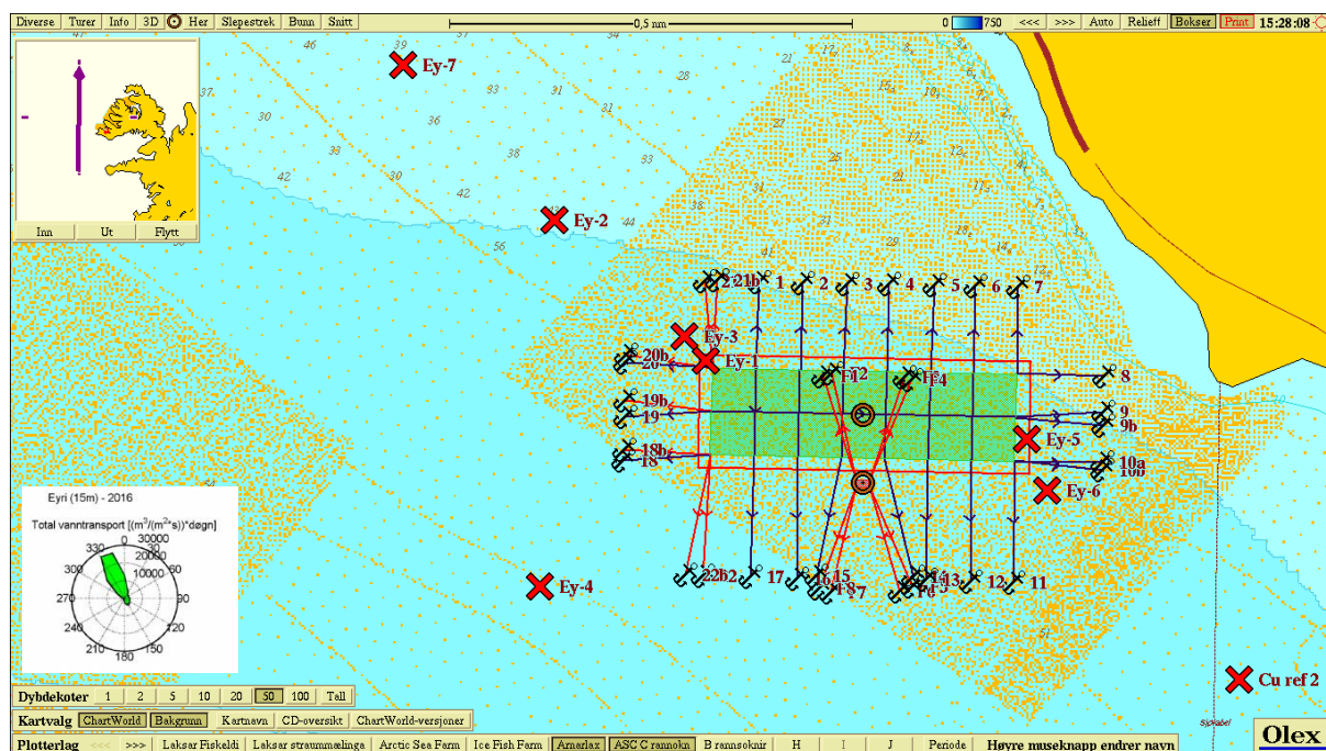
Figur 2. Stasjonskart, ASC Eyri, 2018. Grense for AZE inntegnet som rød linje med avstand på 30 m fra rammen til anlegget. Spredningsstrøm er målt på 15 meters dyp.
